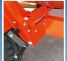
Adjustmet of auger grain flow Règlage du débit de recirculation
